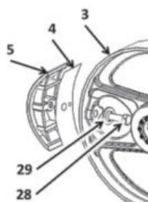
Atornillar y apretar los tornillos 28 con sus arandelas 29 y comprobar atentamente la alineación correcta de los patines 5 con la rueda 3.
