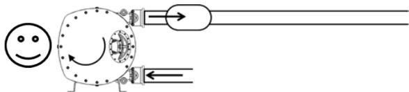
Cambiar la posición de la bomba o de sus orificios en lugar de multiplicar los codos.
