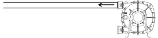
En el caso de una instalación con mangueras flexibles, es imperativo soportarlas o sujetarlas para evitar el batido de las mismas al presurizar la instalación o para limitar el alcance en caso de rotura de una manguera.
