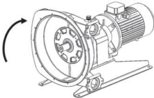
Remontar la rueda (ver § DESMONTAJE DE LA RUEDA), remontar el tubo (ver § CAMBIO DEL TUBO) y llenar la bomba de lubricante (ver § CAMBIO DEL LUBRICANTE).
