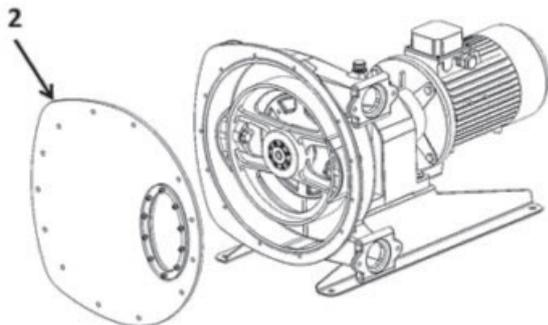
Atornillar y apretar los tornillos 33 con sus arandelas 34 comenzando por la cima para mantener la tapa.
