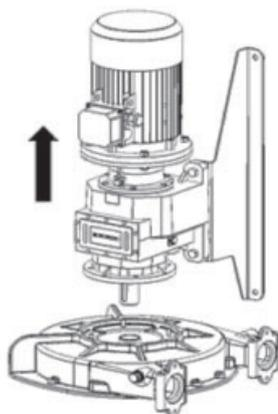
Retirar la junta del eje 26 del cuerpo de bomba. Poner una junta del eje 26 nuevo en el cuerpo de bomba.
