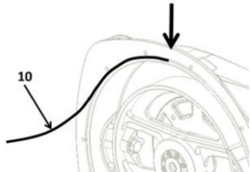
Montage incorrect : risque de fuite et mise sous vide du corps impossible.
