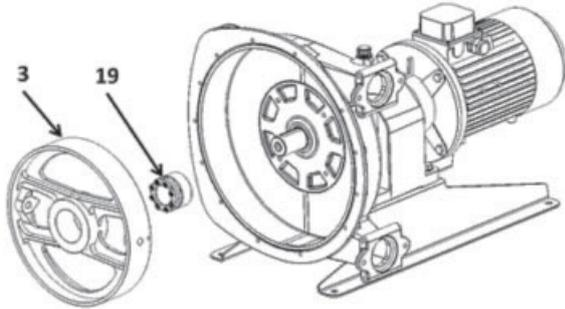
Positionner la roue 3 de façon à respecter la distance B entre la face extérieure de la roue et le fond du corps 1.
