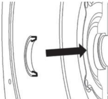
S'il est nécessaire de remplacer la bague de frottement 27, utiliser un marteau et un burin pour casser et retirer la bague 27.
