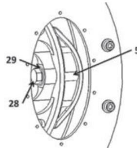
Tirer sur le patin 5 et ses cales 4, d'abord dans le sens radial pour dégager la goupille puis vers l'extérieur de la pompe.
