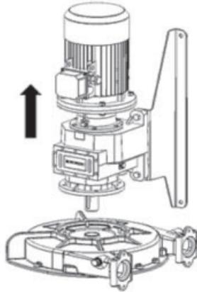
Retirer le joint d'arbre 26 du corps de pompe. Mettre un joint d'arbre 26 neuf dans le corps de pompe.
