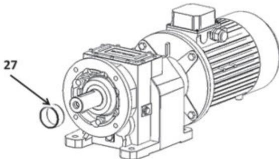
Chauffer la bague neuve à  $110 \pm 10^\circ\text{C}$  /  $230 \pm 50^\circ\text{F}$ .
