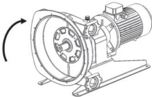
Remonter la roue (voir § DÉMONTAGE DE LA ROUE), remonter le tuyau (voir § REMPLACEMENT DU TUYAU) et remplir la pompe de lubrifiant (voir § REMPLACEMENT DU LUBRIFIANT).
