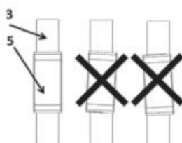
Faire tourner la roue lentement et vérifier qu'aucune pièce ne vient frotter contre le corps.
