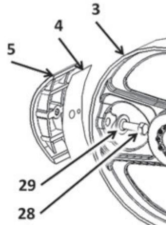
Sur le moyeu de roue 19, desserrer toutes les vis. Mettre cinq vis dans les trous d'extraction pour débloquer le moyeu.
