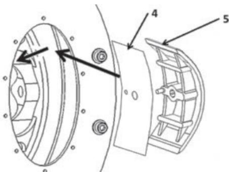
Vérifier le joint de fenêtre 46 et le remplacer si nécessaire.
