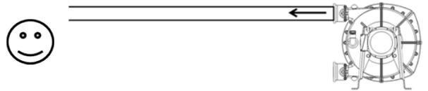
Dans le cas d'une installation avec tuyaux flexibles il est impératif de maintenir ou d'attacher ces derniers afin d'éviter le fouettement lors de la mise en pression de l'installation ou de limiter le trajet en cas de rupture d'un flexible.
