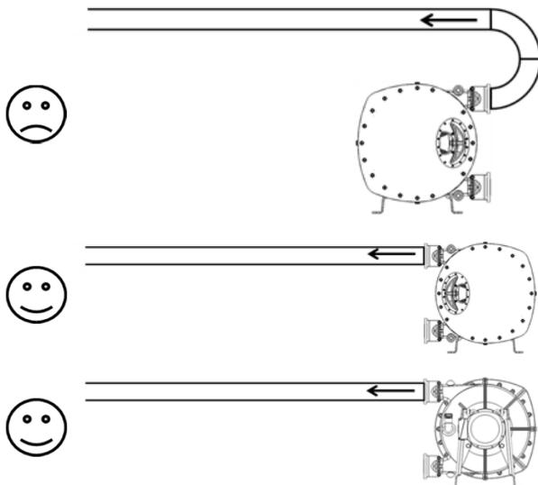
En el caso de una instalación con mangueras flexibles, es imperativo soportarlas o sujetarlas para evitar el batido de las mismas al presurizar la instalación o para limitar el alcance en caso de rotura de una manguera.
