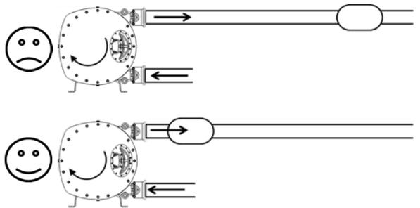
Cambiar la posición de la bomba o de sus orificios en lugar de multiplicar los codos.
