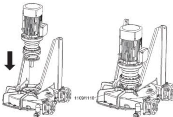
Poner los espárragos 41 y tuercas 42 (HD50 - HD65) o los tornillos 1109 con sus arandelas 1110 (HDX65 - HDX80 - HD80) y apretar.
