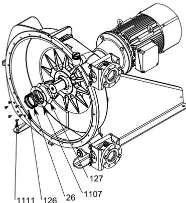
Remontar la rueda (ver § DESMONTAJE DE LA RUEDA), remontar el tubo (ver § CAMBIO DEL TUBO) y llenar la bomba de lubricante (ver § CAMBIO DEL LUBRICANTE).
