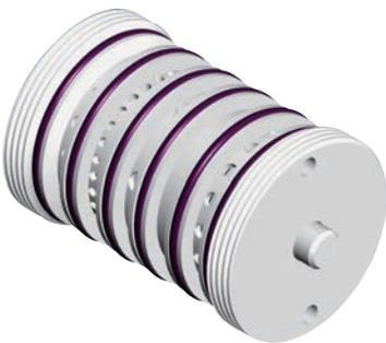
Das Luftsteuersystem hat die Aufgabe, den indirekt über die Membranbewegung gesteuerten, automatischen Betrieb zu gewährleisten. Ist der Endpunkt eines Hubes erreicht, erfolgt eine selbsttätige Umschaltung und der Zyklus – Ansaughub bei einer Membrane, Verdrängung des Fördermediums bei der anderen – wiederholt sich in umgekehrter Reihenfolge.
