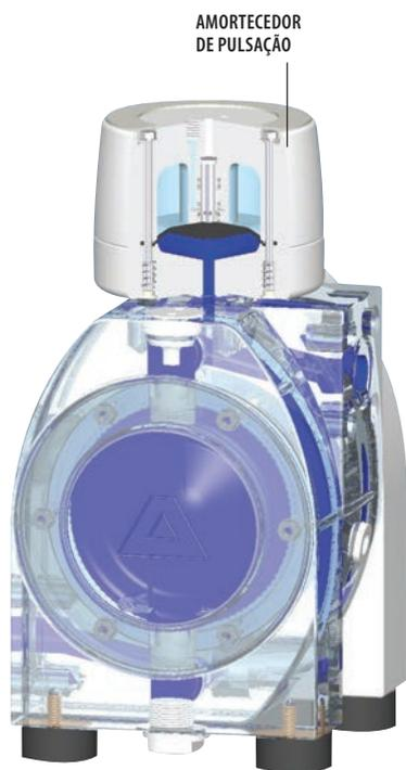
Devido ao design delas, as bombas com ação de oscilação produzem um fluxo pulsante. Embora o design de funcionamento duplo da Série E e o acionamento pneumático direto já tenham reduzido bastante a pulsação, um amortecedor de pulsação ainda deve ser instalado no lado da distribuição a fim de obter um fluxo praticamente uniforme.
