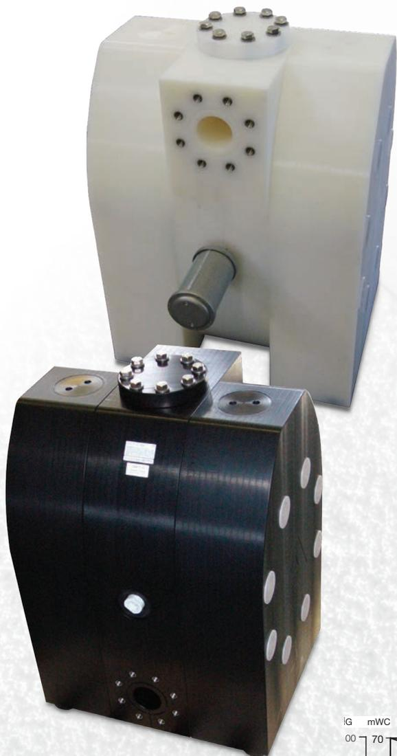
O tamanho E 80 da bomba amplia o alcance da Série E a sete tamanhos. Com uma capacidade máxima de 48 m<sup>3</sup>/h, a E 80 é adequada para uma circulação eficiente de grandes quantidades. O material do compartimento é PE ou PE condutor. Os parafusos do compartimento não são presos em um anel. O uso de arruelas de pressão permite maior segurança e menor suscetibilidade a vazamentos.
