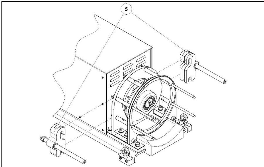
Die Nuthaken (Pos.5) werden mit deren Nuten an den Distanzbolzen bzw. Hutmuttern des Ringantriebes eingehängt.
