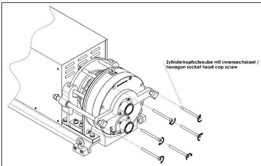
Alle Innensechskantschrauben werden für die Befestigung der Förderkammer werden mit dem vorgesehenen Drehmoment fest angezogen.
