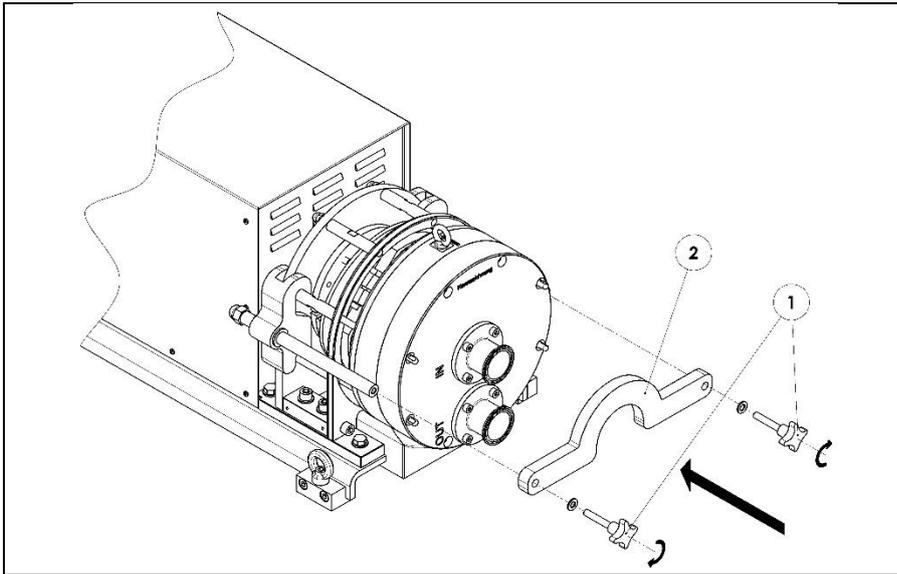
Die Förderkammer wird durch den Anschraubadapter (Pos. 2) mit Hilfe der Kreuzgriffschrauben (Pos. 1) angeschraubt bis sie Kontakt zum Ringantrieb hat.
