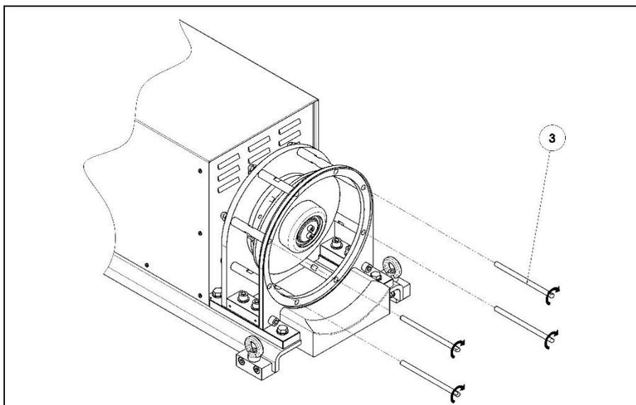
Einschrauben der Führungselemente (Pos. 3) in die Gewindebohrungen des Ringantriebes mit Hilfe eines Maulschlüssels.
