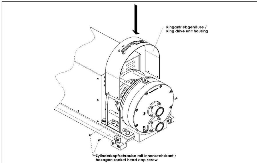
Das Ringantriebgehäuse wird auf dem Ringantrieb montiert und durch die Innensechskantschrauben fixiert.
