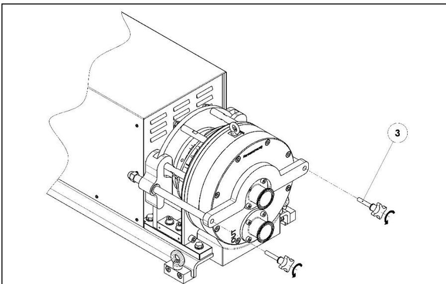
Die Kreuzgriffschrauben (Pos. 1) werden wieder herausgedreht und die restlichen Bestandteile der Montagehilfe demontiert.
