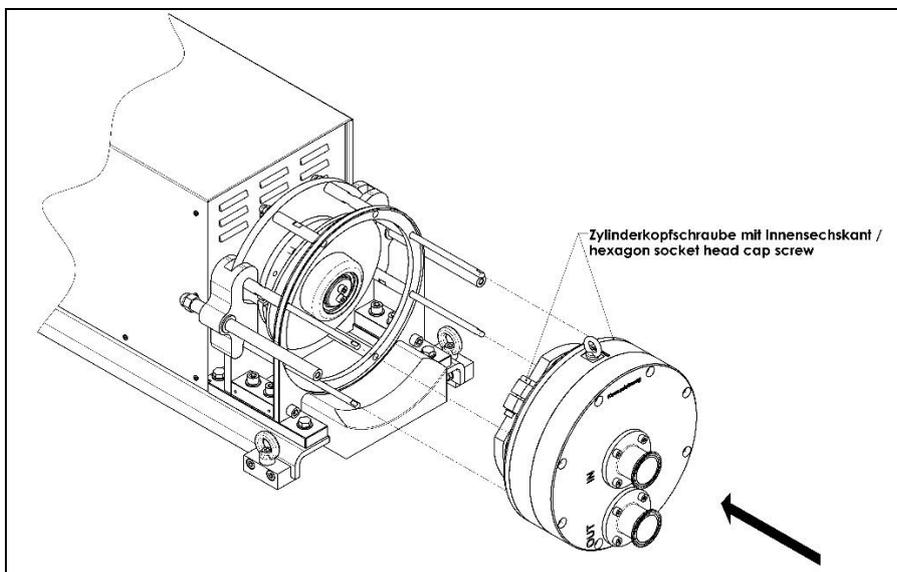
Bevor die Förderkammer montiert werden kann, ist zu beachten, dass die Innensechskantschrauben des Klemmrings gelöst sind.
