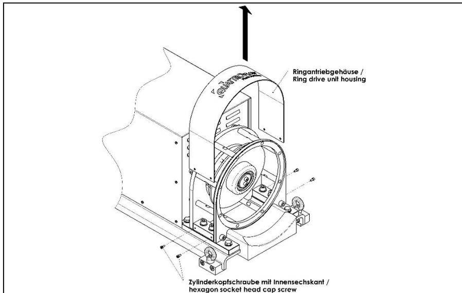
Lösen der Innensechskantschrauben und Demontage des Ringantriebgehäuses nach oben hin.
