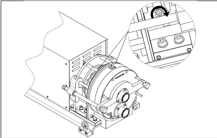
Die beiden Innensechskantschrauben für die Fixierung des Klemmrings werden mit dem vorgesehenen Drehmoment fest angezogen.
