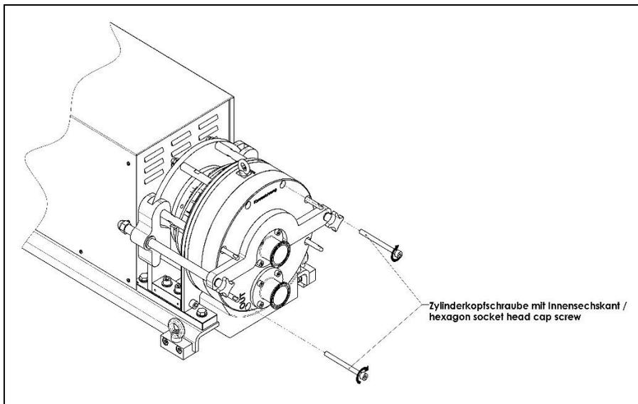
Die Förderkammer wird mit zwei handfest angezogenen Innensechskantschrauben fixiert.
