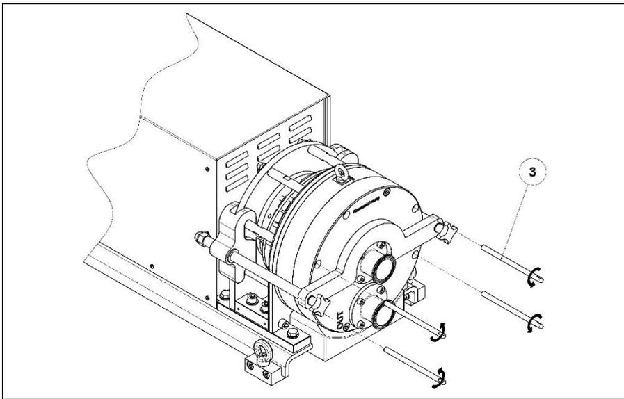
Die Führungselemente (Pos. 3) werden aus dem Ringantrieb herausgeschraubt.
