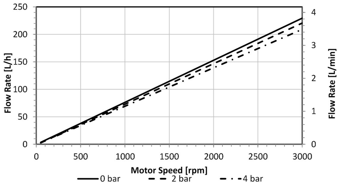
Die Fördermengen, die in der Kennlinie angegeben sind, wurden mit einer Förderkammer unter Standardbedingungen nach der Endmontage der Pumpe ermittelt.
