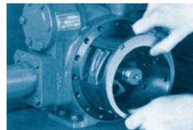
El revestimiento reemplazable restaura la eficiencia con facilidad.
