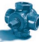
**Válvula de cuatro direcciones:** Las válvulas de cuatro direcciones permiten una sencilla conmutación de la operación de transferencia de líquido a recuperación de vapor, al invertir la dirección de flujo del sistema. Las válvulas estándar son de hierro dúctil con una agarradera y un indicador de dirección de flujo fácil de leer. Se dispone de válvulas con activación eléctrica o neumática, en caso de desearse una operación remota.
