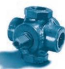
**Vanne à quatre voies:** Les vannes à quatre voies permettent de passer du transfert de liquide à la récupération de vapeur en inversant le sens de l'écoulement dans le système. Les vannes standard sont construites en fonte ductile avec une poignée et un indicateur de sens d'écoulement facile à lire. Des vannes à actionneurs électriques ou pneumatiques sont disponibles si l'on envisage une commande à distance.
