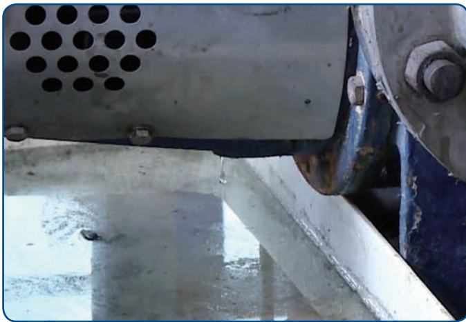
在生产过程中齿轮泵出现的问题非常严重，一到两个月就会发生泄露。
