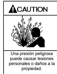
(PRECAUCIÓN) Los ajustes incorrectos de la válvula de alivio de la presión pueden causar fallas de los componentes de la bomba, lesiones personales y daños a la propiedad.
