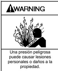
(ADVERTENCIA) Desconectar los componentes de contención del fluido o de la presión durante la operación de la bomba puede causar lesiones personales graves, muerte o daños importantes a la propiedad.
