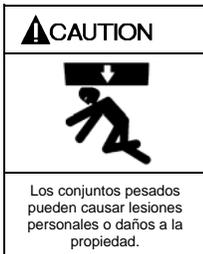
(PRECAUCIÓN) Siempre utilice un dispositivo de izado capaz de soportar el peso total de los conjuntos de las bombas.
