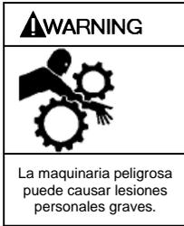
(ADVERTENCIA) Si no se desconecta y bloquea la potencia eléctrica o la unidad de accionamiento del motor antes de iniciarse el mantenimiento, pueden provocarse lesiones personales graves o la muerte.
