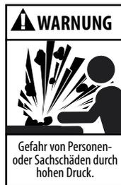
Wenn der Systemdruck vor der Durchführung von Wartungs- oder Instandhaltungsarbeiten an der Pumpe nicht entlastet wird, kann es zu Personen- oder Sachschäden kommen.
