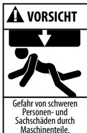
Stets eine Hubeinrichtung verwenden, die das komplette Gewicht der Pumpenteile tragen kann.
