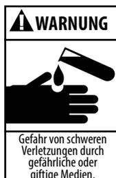
Wenn die Pumpe mit gefährlichen oder giftigen Medien verwendet wurde, muss das System vor der Durchführung von Wartungsarbeiten gespült werden.
