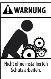
Der Betrieb ohne installierte Schutzvorrichtungen kann schwere Sach- und Personenschäden oder tödlichen Verletzungen verursachen.
