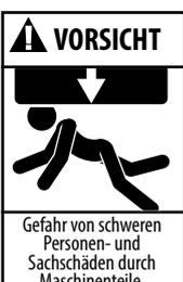
Stets eine Hubeinrichtung verwenden, die das komplette Gewicht der Pumpenteile tragen kann.
