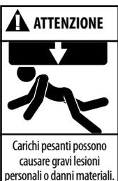
Utilizzare sempre un dispositivo di sollevamento in grado di supportare il peso delle varie parti della pompa.
