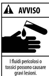
Nei casi in cui sono state effettuate operazioni di pompaggio di fluidi pericolosi o tossici, il sistema deve essere lavato e decontaminato, dentro e fuori, prima di eseguire le operazioni di assistenza o manutenzione.
