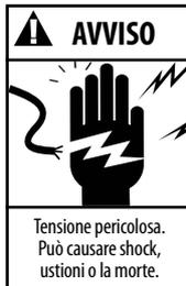
Un errore di disconnessione e il blocco dell'energia elettrica prima di procedere con le operazioni di manutenzione possono causare shock, ustioni o la morte.
