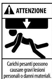
Utilizzare sempre un dispositivo di sollevamento in grado di supportare il peso delle varie parti della pompa.
