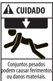
Use sempre um dispositivo de elevação capaz de suportar todo o peso do conjunto da bomba.
