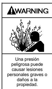
**(ADVERTENCIA)** Desconectar los componentes de contención del fluido o de la presión durante la operación de la bomba puede causar lesiones personales graves o daños a la propiedad.
