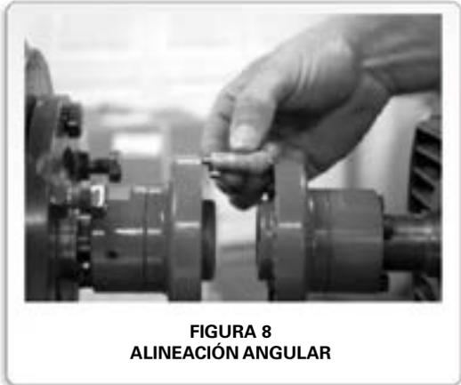
Con los cubos de acoplamiento inmóviles, utilice un micrómetro para interiores o un calibrador para medir la separación entre los cubos de acoplamiento a intervalos de 90 °. Ajuste o calce el equipo hasta que la diferencia de separación en todos los puntos alrededor de los cubos sea inferior al valor indicado en la Tabla 1 de la página 13.
