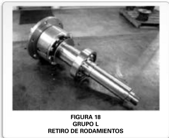
Los extremos de accionamiento del grupo L utilizan un anillo de sujeción (artículo 253B) en lugar de un anillo de sujeción axial para retener el rodamiento de empuje en el porta rodamientos. Consulte la vista en sección en el Anexo VIII. Extraiga la unidad eje/soportes de rodamientos de la caja de rodamientos como en las bombas de los grupos S y M indicadas anteriormente. Entonces...
