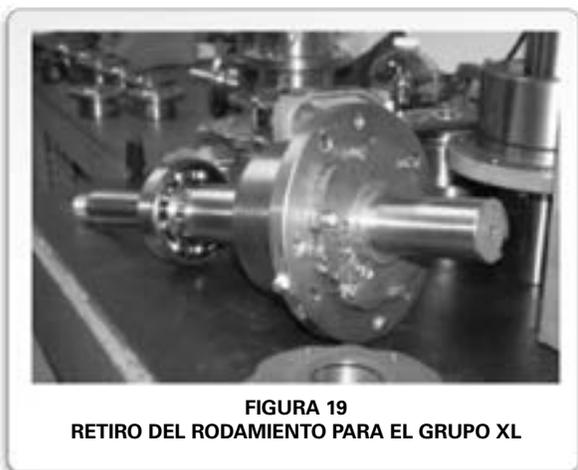
el rodamiento de empuje se sujeta en el porta rodamientos con una cubierta de rodamientos (artículo 109A). Consulte la vista en sección de las bombas con caja de rodamientos XL en el Anexo VIII. Extraiga la unidad eje/soportes de rodamientos de la caja de rodamientos como en las bombas de los grupos S y M indicadas anteriormente. Entonces...
