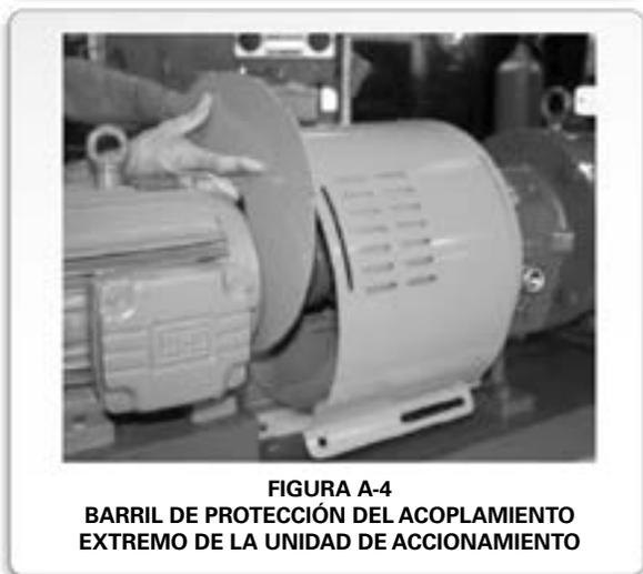
4. Separe ligeramente la parte inferior de la mitad de la protección del acoplamiento (extremo de la unidad de accionamiento) y colóquela sobre la mitad de la protección del acoplamiento (extremo de la bomba) de modo que las ranuras de apoyo de la mitad de la protección del acoplamiento (extremo de la unidad de accionamiento) queden orientadas hacia la unidad de accionamiento, como se muestra en la *Figura A-3*.
