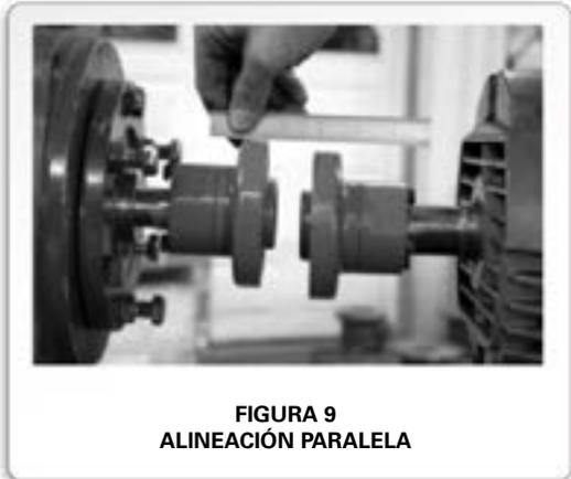
Con los cubos de acoplamiento inmóviles, coloque una regla plana contra el borde del cubo de acoplamiento para determinar las desviaciones de alineación vertical y horizontal. Ajuste o calce el equipo hasta que el borde recto quede plano contra ambas llantas del cubo, de forma vertical y horizontal.
