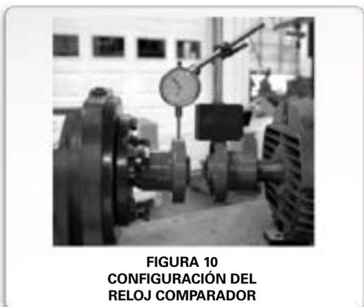
1. Trace o marque líneas de índice sobre ambos cubos de acoplamiento para indicar dónde se apoya el punto del reloj comparador.
