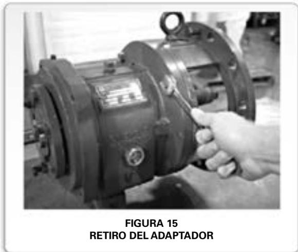
Los adaptadores de la caja de rodamientos se utilizan en las bombas de los grupos M, L y XL. No se utilizan en las bombas del grupo S de 6" y los adaptadores de anillo se utilizan en las bombas del grupo S de 8".
