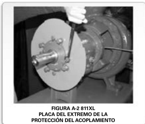
2. Separe ligeramente la parte inferior de la mitad de la protección del acoplamiento (extremo de la bomba) y colóquela sobre la placa del extremo de la bomba, como se muestra en la *Figura A-3*. Las ranuras de apoyo de la mitad de la protección están situadas alrededor de la placa del extremo.
