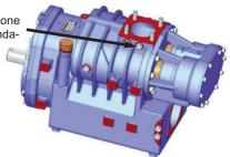
Se a livello, del foro di scarico del compressore la pressione supera il valore massimo in funzione della relativa velocità di rotazione, la valvola di protezione deve essere sostituita da una valvola con caratteristiche adeguate.
