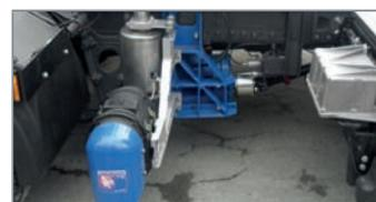
Sistema non raffreddato per trasmissione diretta Telaio stretto
