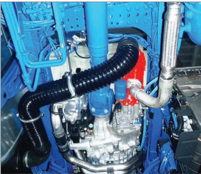
Montage direct de l'ensemble compresseur sur la boîte de vitesses
