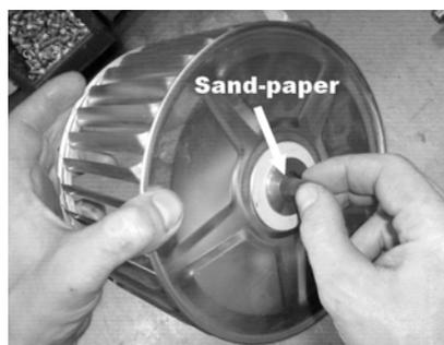
Monter sans forcer le ventilateur sur l'axe du moteur.
