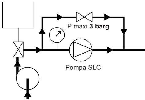
È preferibile non far girare la pompa Serie SL durante il CIP, sebbene una bassa velocità di rotazione (<100 rpm) è accettabile in condizioni alternate di marcia ed arresto.
