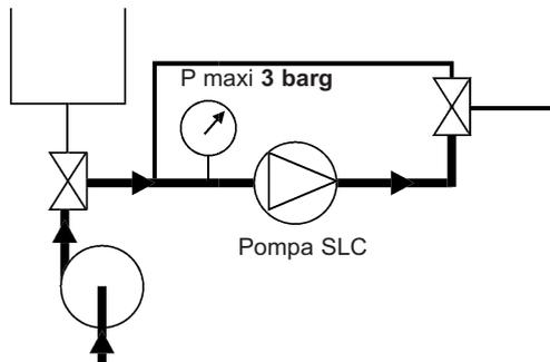
È preferibile non far girare la pompa Serie SL durante il CIP, sebbene una bassa velocità di rotazione (<100 rpm) è accettabile in condizioni alternate di marcia ed arresto.
