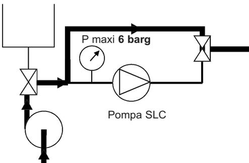
La pompa non deve assolutamente ruotare durante questa operazione.
