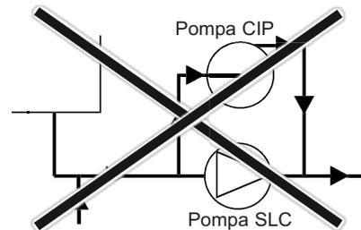
In effetti, in questo caso, la pressione all'aspirazione della pompa Serie SL è inferiore a quella di mandata, ed il pistone rimane forzato nel cilindro.
