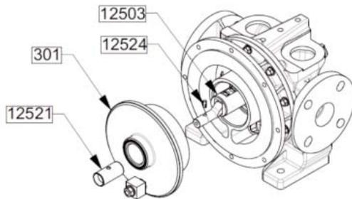
Die Kontaktflächen des Kolbens 301 mit einem Mittel schmieren, das mit der gepumpten Flüssigkeit kompatibel ist.
