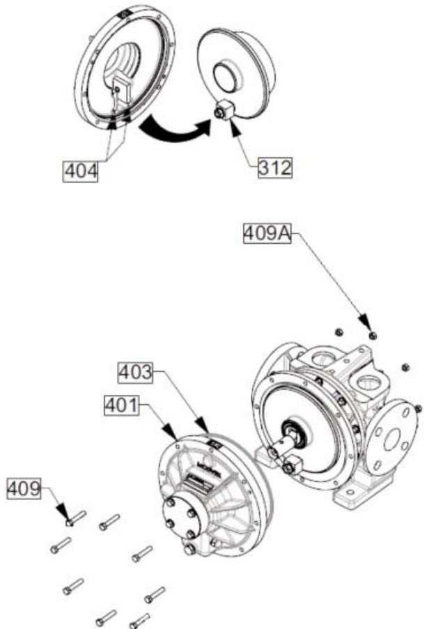
Den Dichtungssitz 403 reinigen.
