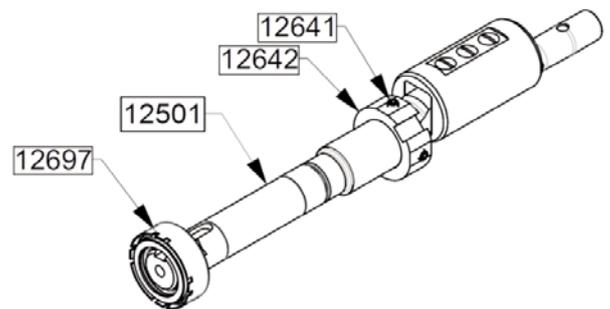
Den Oberflächenzustand der Welle 12501 überprüfen, im Fall von Kratzern rechts vom O-Ring des drehenden Teils der Gleitringdichtung mit feinem Schleifpapier bearbeiten. Es sollte besonders auf parallel zur Wellenachse verlaufende Kratzer geachtet werden, die unbedingt vermieden werden müssen.
