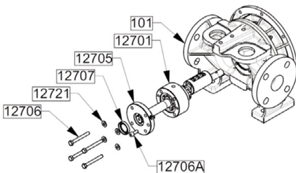
Die Lippendichtung 12707 (Lippe nach außen gerichtet) im Lagerdeckel 12705 montieren.
