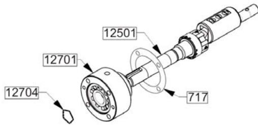
Die Einheit Lagergehäuse (12701 - 12703 - 12733 - 12627 und stehenden Gleitring der Gleitringdichtung) auf die Welle 12501 montieren
