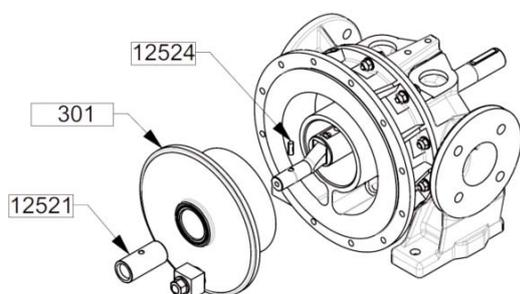
Lubrifier les faces de frottement du piston 301 avec un produit compatible avec le liquide pompé.
