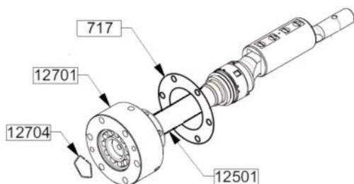
Monter l'ensemble cage de roulement (12701 - 12703 - 12733 - 12627 et contrepartie fixe de la garniture) sur l'arbre 12501.
