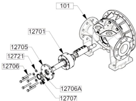
Monter le joint à lèvres 12707, lèvre orientée vers l'extérieur dans le couvercle de roulement 12705.
