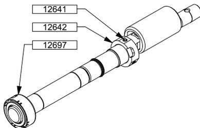
Den Oberflächenzustand der Welle 12501 überprüfen, im Fall von Kratzern rechts vom O-Ring des drehenden Teils der Gleitringdichtung mit feinem Schleifpapier bearbeiten. Es sollte besonders auf parallel zur Wellenachse verlaufende Kratzer geachtet werden, die unbedingt vermieden werden müssen.
