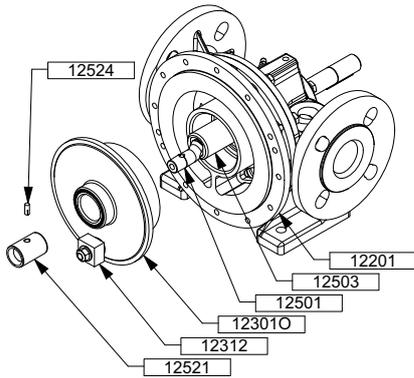
Die Kontaktflächen des Kolbens 301 mit einem Mittel schmieren, das mit der gepumpten Flüssigkeit kompatibel ist.
