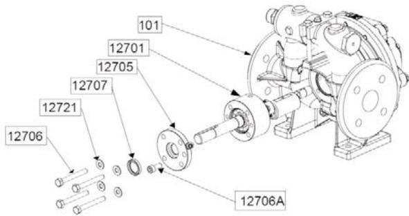
Die Lippendichtung 12707 (Lippe nach außen gerichtet) im Lagerdeckel 12705 montieren.
