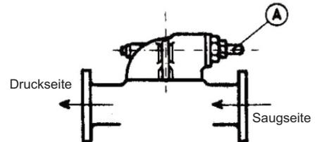
Die Schrauben 12706 und ihre neuen, gerippten, konischen Scheiben 12721 mit mittlerer Schraubensicherung anbringen.
