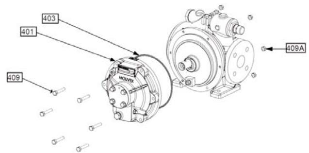
Den Dichtungssitz 403 reinigen.
