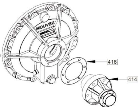
Montage de la bague de fond dans le nouveau coussinet
