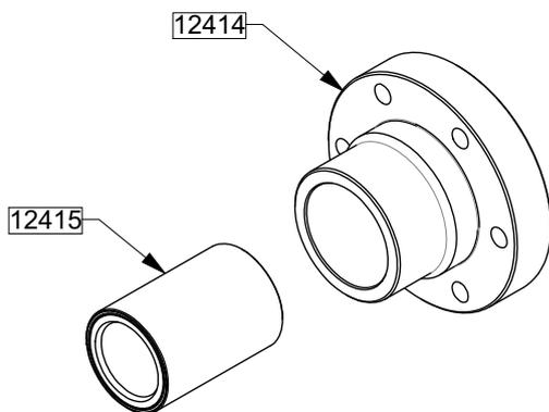
Orienter le chanfrein de la bague côté extérieur (voir schéma ci-dessus).
