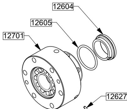
Le cas échéant, nettoyer le roulement 12703 de sa graisse.
