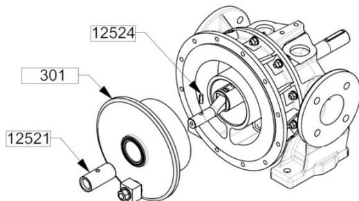
Lubrifier les faces de frottement du piston 301 avec un produit compatible avec le liquide pompé.
