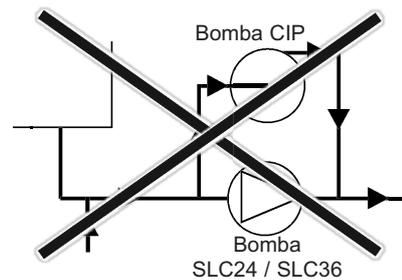
En efecto, en este caso, la presión a la entrada de la bomba SLC24 / SLC36 es inferior a la presión en salida y el pistón permanece pegado sobre el cilindro. Entonces la bomba SLC24 / SLC36 ya no es pasante. Por lo tanto, ya no se asegura su correcta limpieza y el conjunto cilindro/pistón se desgastará prematuramente.
