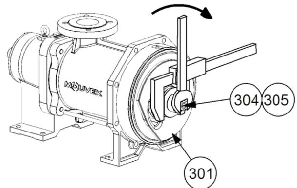
**Es imprescindible sujetar bien el pistón, ya que su rotación puede provocar el deterioro del fuelle.**
