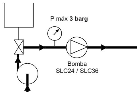
Es preferible no hacer girar la bomba SLC24 / SLC36 durante el CIP, pero se acepta una velocidad (< 100 rpm) o funcionamiento /parada alternada.
