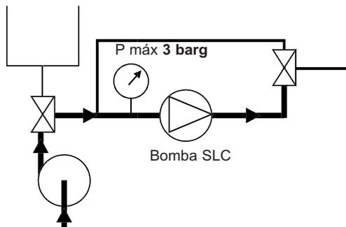
Es preferible no hacer funcionar la bomba SLC24 / SLC36 durante el CIP, pero se acepta una velocidad baja (< 100 rpm) o funcionamiento /parada alternada.
