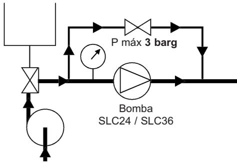
Es preferible no hacer funcionar la bomba SLC24 / SLC36 durante el CIP, pero se acepta una velocidad baja (< 100 rpm) o funcionamiento /parada alternada.
