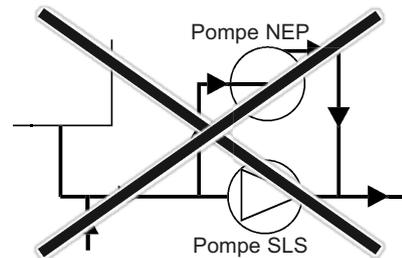
En effet, dans ce cas, la pression à l'entrée de la pompe Série SLS est inférieure à la pression en sortie et le piston reste plaqué sur le cylindre. La pompe Série SLS n'est alors plus passante. Son bon nettoyage n'est donc plus assuré et le couple cylindre/piston s'usera prématurément.
