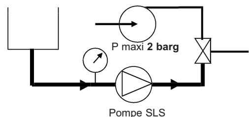
Il est recommandé de limiter la vitesse de rotation de la pompe Série SLS.
