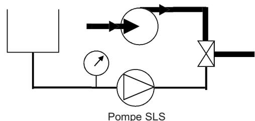
La pompe Série SLS est arrêtée pendant le nettoyage de l'installation.
