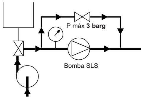
Es preferible no hacer funcionar la bomba Serie SL durante el CIP, pero se acepta una velocidad baja (< 100 rpm) o funcionamiento /parada alternada.
