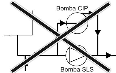
En efecto, en este caso, la presión a la entrada de la bomba Serie SL es inferior a la presión en salida y el pistón permanece pegado sobre el cilindro. Entonces la bomba Serie SL ya no es pasante. Por lo tanto, ya no se asegura su correcta limpieza y el conjunto cilindro/pistón se desgastará prematuramente.
