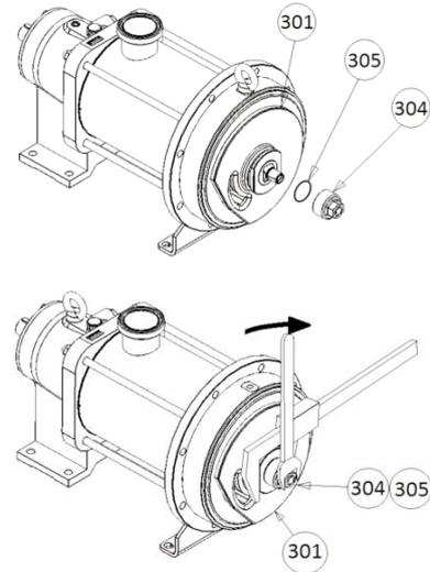
**Es imprescindible sujetar bien el pistón, ya que su rotación puede provocar el deterioro del fuelle.**
