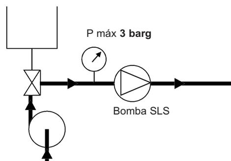
Es preferible no hacer girar la bomba Serie SL durante el CIP, pero se acepta una velocidad (< 100 rpm) o funcionamiento /parada alternada.
