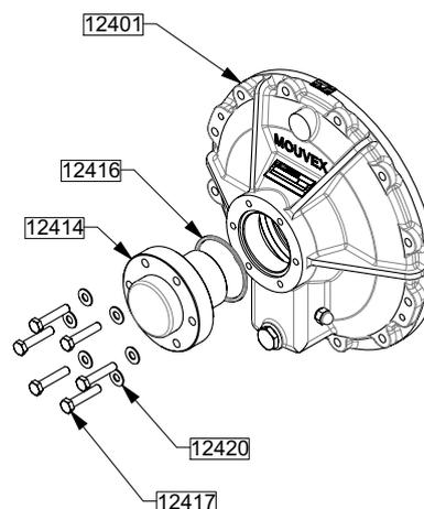
Den Dichtungssitz 12416 reinigen.
