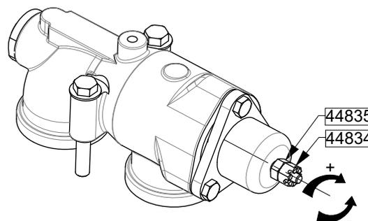
Die Einstellung ist richtig, wenn die Fördermenge der vorgesehenen Menge entspricht und wenn der Motor den beim Schließen des Druckkreises entstehenden Überdruck und den damit verbundenen Belastungsanstieg ohne Probleme verkraftet. Auf diese Weise werden die Überströmventile unserer Pumpenaggregate entsprechend Informationen des Technischen Kundendienstes eingestellt.
