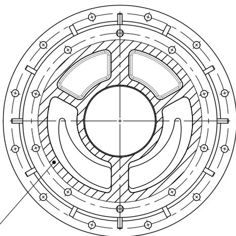
Auftragsfläche für das Dichtungsmittel
