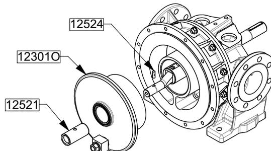
Die Kontaktflächen des Kolbens 12301O mit einem Mittel schmieren, das mit der gepumpten Flüssigkeit kompatibel ist.
