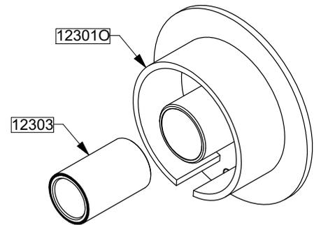
Den Ring 12303 mit Hilfe einer Presse und eines Zylinderstücks vom Kolben 123010 abziehen.
