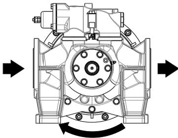
Die Umkehr der Drehrichtung darf nur nach einem kompletten Stopp der Pumpe erfolgen.
