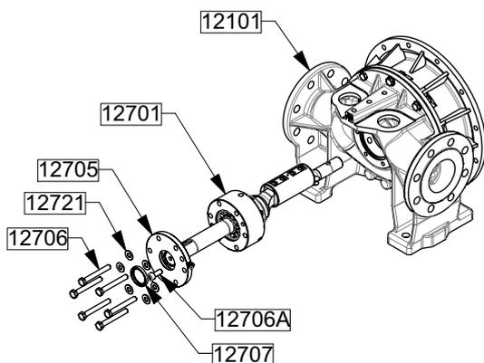
Gegebenenfalls die Lippendichtung 12707 (Lippe nach außen gerichtet) im Lagerdeckel 12705 montieren.
