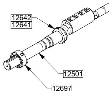
Die Welle 12501 (Mitnehmer-Ring 12641 und seine Schrauben 12642) vom rotierenden Gleitring 12697 abziehen. Dabei nicht zerkratzen!
