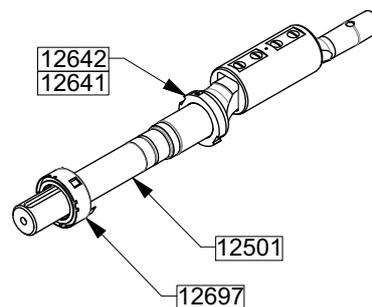
Den Oberflächenzustand der Welle 12501 überprüfen, im Fall von Kratzern rechts vom O-Ring des drehenden Teils der Gleitringdichtung mit feinem Schleifpapier bearbeiten. Es sollte besonders auf parallel zur Wellenachse verlaufende Kratzer geachtet werden, die unbedingt vermieden werden müssen.
