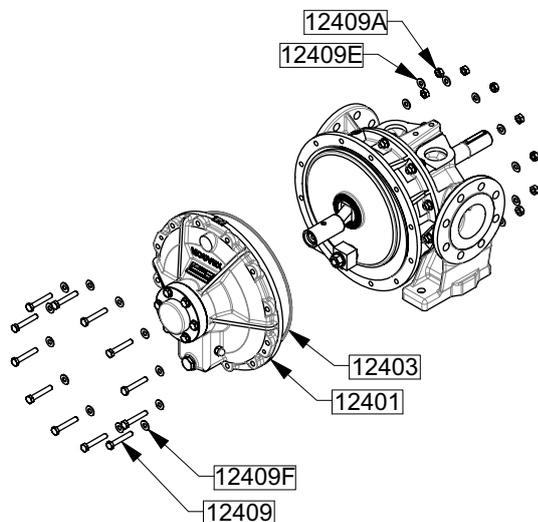
Die Bolzen des Gehäusedeckels (Schrauben 12409, Muttern 12409A und Scheiben 12409E - 12409F) entfernen.
