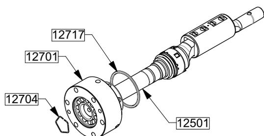
Die Einheit Lagergehäuse (12701 - 12703 - 12733 - 12627 und stehenden Gleitring der Gleitringdichtung) auf die Welle 12501 montieren
