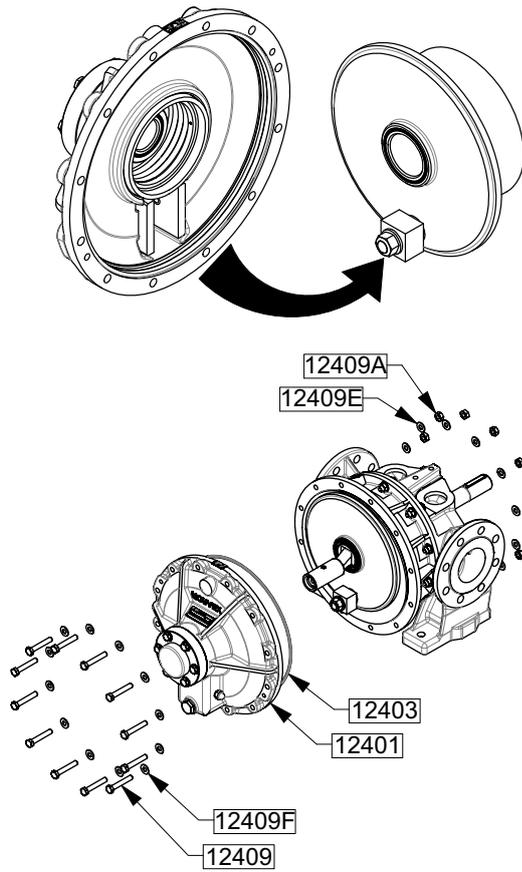
Den Dichtungssitz 12403 reinigen.
