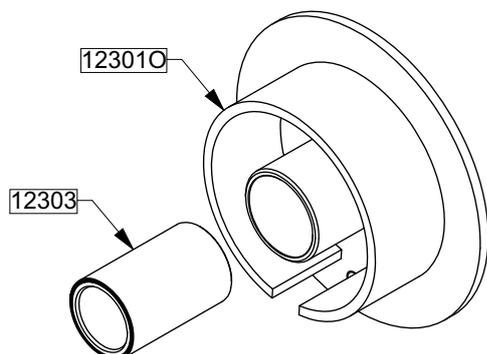
Die Buchse 12303 mit Hilfe einer Presse und eines Zylinderstücks in den Kolben 123010 drücken, bis die Seiten der Buchse und des Kolbens fluchten (auf beiden Seiten).
