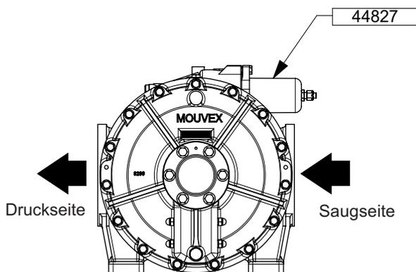
Diese Kontrolle ist für ein doppeltes Überströmventil nicht notwendig, da die Pumpe in diesem Fall in beiden Betriebsrichtungen abgesichert ist.
