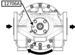
Die Schraube 12706 muss sich auf der Saugseite befinden. Diese Position gewährleistet einen besseren internen Umlauf des Produkts, was einen Temperaturanstieg vermeidet. Sie führt jedoch zu einem geringeren Selbstansaugvermögen und kann, insbesondere bei Medien mit geringer Viskosität, zu einer Verringerung des Förderstromes führen. **Kontaktieren Sie uns bitte für jegliche Fragen bezüglich dieser Konfiguration.**
