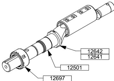
Die Welle 12501 (Mitnehmer-Ring 12641 und seine Schrauben 12642) vom rotierenden Gleitring 12697 abziehen. Dabei nicht zerkratzen!
