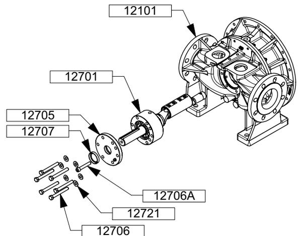
Gegebenenfalls die Lippendichtung 12707 (Lippe nach außen gerichtet) im Lagerdeckel 12705 montieren.
