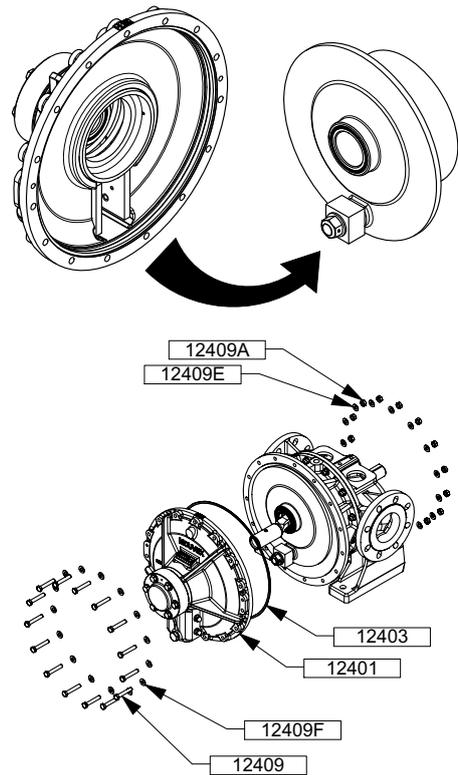
Den Dichtungssitz 12403 reinigen.
