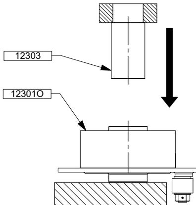
Die Buchse 12303 mit Hilfe einer Presse und eines Zylinderstücks in den Kolben 123010 drücken, bis die Seiten der Buchse und des Kolbens fluchten (auf beiden Seiten).
