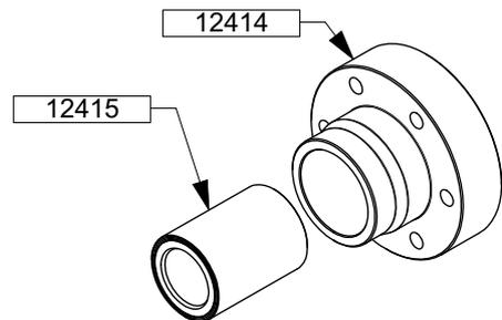
**Kohle-Buchse** : Die Kohlebuchse 12415 mit Hilfe eines Kunststoffhammers und eines Meißels zerbrechen und dabei darauf achten, dass das Frontdeckellager 12414 nicht beschädigt wird. Den Metallteil der Buchse 12415 mit Hilfe eines Abziehers abziehen.
