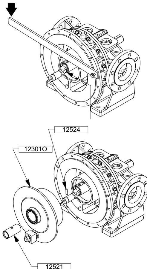
Die Kontaktflächen des Kolbens 12301O mit einem Mittel schmieren, das mit der gepumpten Flüssigkeit kompatibel ist.
