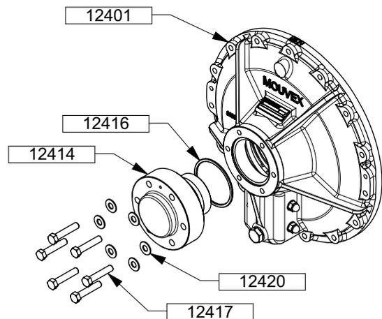
Den Dichtungssitz 12416 reinigen.
