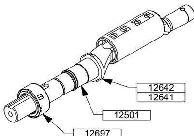
Den Oberflächenzustand der Welle 12501 überprüfen, im Fall von Kratzern rechts vom O-Ring des drehenden Teils der Gleitringdichtung mit feinem Schleifpapier bearbeiten. Es sollte besonders auf parallel zur Wellenachse verlaufende Kratzer geachtet werden, die unbedingt vermieden werden müssen.
