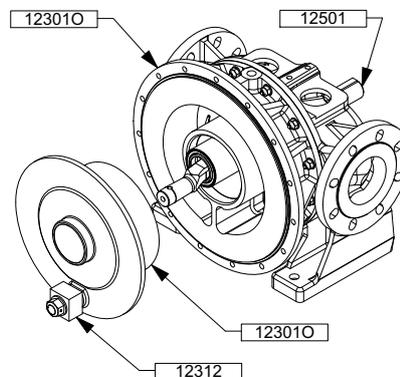
Den Kolben 12301O abziehen.
