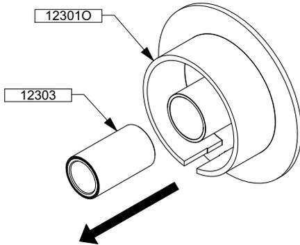
Den Ring 12303 mit Hilfe einer Presse und eines Zylinderstücks vom Kolben 12301O abziehen.
