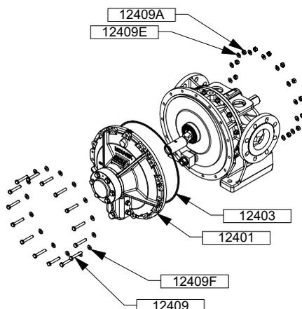
Die Bolzen des Gehäusedeckels (Schrauben 12409, Muttern 12409A und Scheiben 12409E - 12409F) entfernen.
