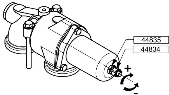
El ajuste es satisfactorio cuando el caudal corresponde al esperado y cuando el motor soporta, sin incidentes, el aumento de potencia debido a la sobrepresión durante el cierre de la descarga. Según la información proporcionada al Servicio técnico, de este modo se ajustan los bypass de nuestros grupos de motobombas o bombas eléctricas.
