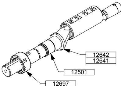
Controlar el estado de la superficie del eje 12501, pasarle una lija fina en caso de rayas perpendicularmente a la junta tórica de la cara giratoria del cierre. Se deberá prestar una atención particular a las rayas paralelas a la línea del eje, que deben evitarse imperativamente.
