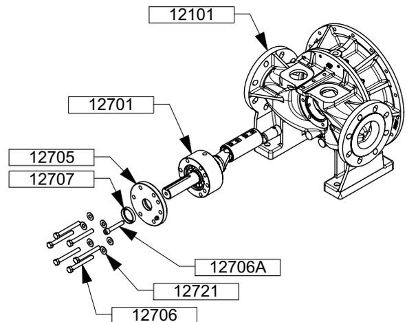
Si fuera necesario, colocar el retén labial 12707 con el labio orientado hacia el exterior en la tapa de rodamiento 12705.
