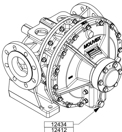
Una vez vaciada la bomba, colocar el tapón 12434 y su junta 12412.
