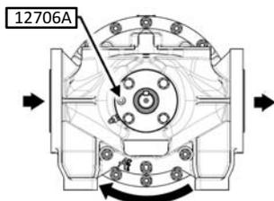
El tornillo 12706A debe estar en el lado aspiración. Esta posición asegura una mejor recirculación interna del producto, evitando un aumento de temperatura. Sin embargo, conlleva una menor capacidad de autocebado y puede significar una disminución del caudal, en particular, en productos de baja viscosidad. **Consúltenos ante cualquier duda relativa a esta configuración.**
