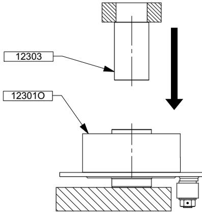
Colocar el casquillo 12303 en el pistón 123010 con una prensa y un cilindro hasta que las caras de ambos estén alineadas (de ambos lados).
