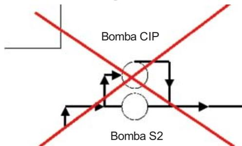
En efecto, en este caso, la presión a la entrada de la bomba S2 es inferior a la presión a la salida y el pistón queda pegado sobre el cilindro. Entonces la bomba S2 no es pasante. Por lo tanto, no estará asegurada su buena limpieza y el conjunto cilindro/pistón se desgastará prematuramente.
