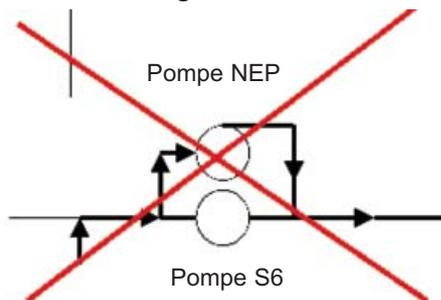
En effet, dans ce cas, la pression à l'entrée de la pompe S6 est inférieure à la pression en sortie, et le piston reste plaqué sur le cylindre. La pompe S6 n'est alors plus passante. Son bon nettoyage n'est donc plus assuré, et le couple cylindre/piston s'usera prématurément.
