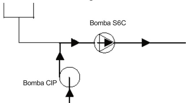
Es preferible no hacer girar la bomba Serie S durante el CIP, pero se acepta una velocidad (< 100 rpm) o funcionamiento /parada alternada.
