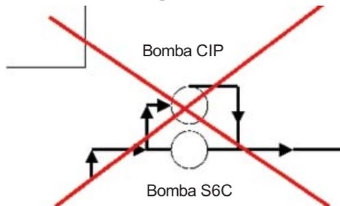
En efecto, en este caso, la presión a la entrada de la bomba S6C es inferior a la presión a la salida y el pistón queda pegado sobre el cilindro. Entonces la bomba S6C no es pasante. Por lo tanto, no estará asegurada su buena limpieza y el conjunto cilindro/pistón se desgastará prematuramente.
