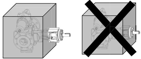
**Cubreacoplamiento** : Para cualquier aplicación con una temperatura de producto bombeado superior a 100 °C, predecir un protege acoplamiento con aerturas para favorecer el enfriamiento del rodamiento del eje.
