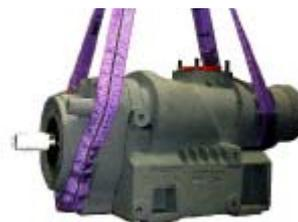
Befestigungsstifte Gewindebohrungen für die Förderflansche können zum Installieren einer Huböse für den Transport des Verdichters verwendet werden.
