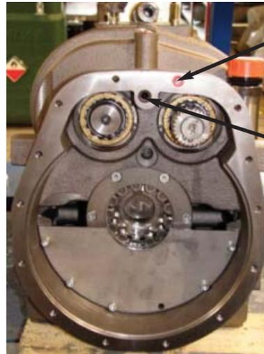
Madenschraube **839** mit Loctite® 510\* montieren
