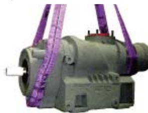
I fili di fissaggio delle flange di mandata possono essere utilizzati per l'installazione di un anello di sollevamento che permetta il trasporto del compressore.
