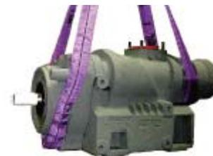
Les taraudages de fixation des brides de refoulement peuvent être utilisés pour l'installation d'un anneau de levage permettant le transport du compresseur.
