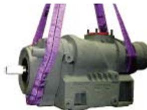
Se puede utilizar los pasadores de fijación de las bridas de descarga para instalar un aro de elevación que permita transportar el compresor.
