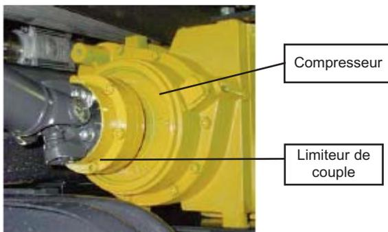
Les packages DDIC peuvent être commandés avec limiteur de couple monté. Se référer à la Notice d'instructions 1401-B00 LIMITEUR DE COUPLE MISTRAL B600 TYPHON II.
