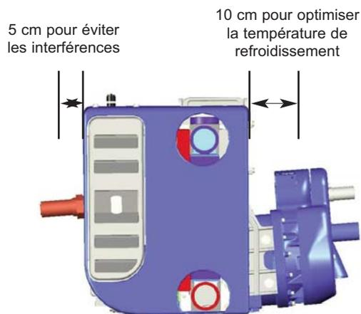
De la même manière, une distance minimale de 5 cm devra être respectée entre tous les accessoires situés dans le châssis (PTO, cardan d'entraînement, ...) et le package compresseur.
