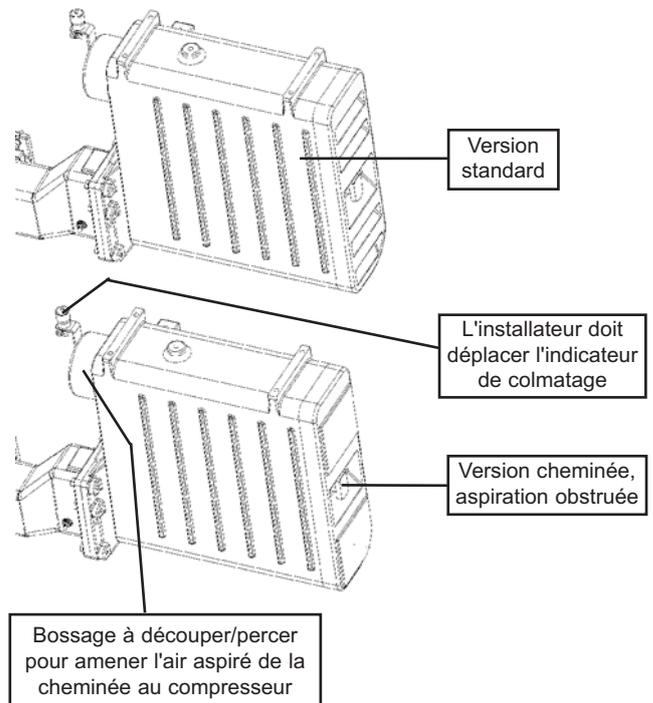
Dans ce cas, l'alimentation en air du compresseur doit se faire par l'arrière de la boîte filtre, sur le bossage de diamètre 140 prévu à cet effet.
