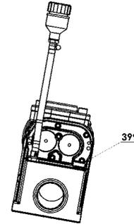
Positionner le bouchon de reniflard dans une zone dégagée afin d'éviter une condensation éventuelle d'huile.
