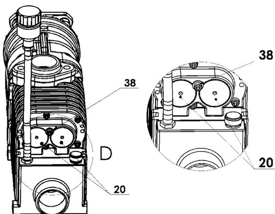
Afin de s'assurer que le compresseur tourne dans la bonne direction, les vis mâle et femelle doivent tourner dans les directions spécifiées sur le schéma ci-dessous quelle que soit la variante d'entraînement (B200 12R et B200 10L) :
