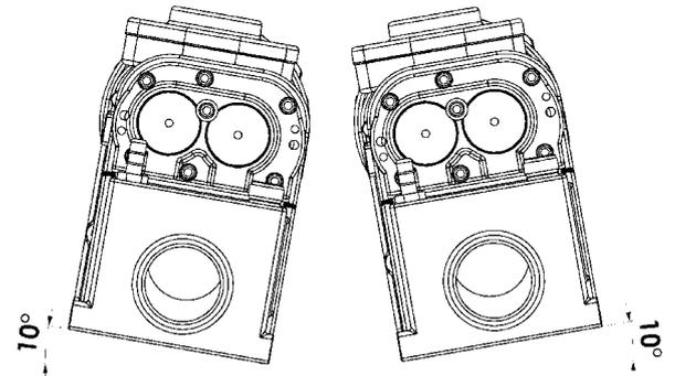
Les jeux de trous taraudés dans le carter multiplicateur 1086 et les lumières du couvercle 3 permettent d'obtenir une inclinaison conforme quelque soit l'inclinaison de la bride de la prise de force.
