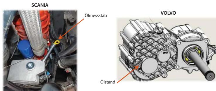
Faire le niveau de la boîte de vitesses selon les préconisations du constructeur camion après le montage du compresseur. Vérifier le niveau d'huile de la boîte de vitesse après 30 min de fonctionnement continu du compresseur et refaire une mise à niveau si nécessaire.
