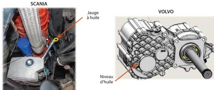
Dopo aver montato il compressore, procedere al rabbocco dell'olio seguendo le istruzioni fornite dal costruttore del camion. Verificare il livello dell'olio della scatola del cambio dopo 30 minuti di funzionamento continuo del compressore e procedere al rabbocco se necessario.
