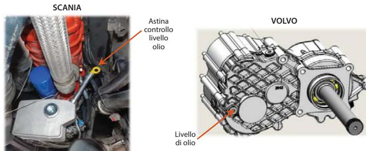
Después de haber montado el compresor, efectuar el relleno del aceite siguiendo las instrucciones del fabricante del tractora. Comprobar el nivel del aceite de la caja de cambios después de 30 minutos de funcionamiento continuo del compresor y efectuar el relleno, si fuera necesario.
