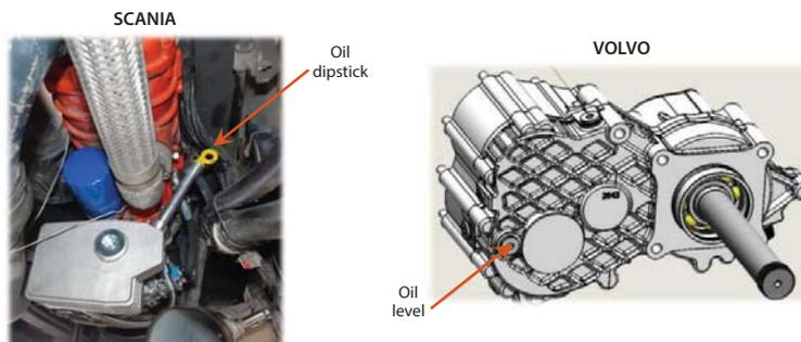
Nachdem Sie den Kompressor zusammengebaut haben, füllen Sie das Öl im Getriebe gemäss den Empfehlungen des Fahrzeugherstellers nach.
