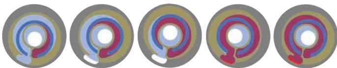
La vitesse linéaire différentielle entre le cylindre et le piston est faible et égale en tout point du piston. Ce mouvement nécessite logiquement moins d'énergie pour être obtenu par rapport aux pompes à pièces rotatives qui présentent généralement une vitesse périphérique élevée.
